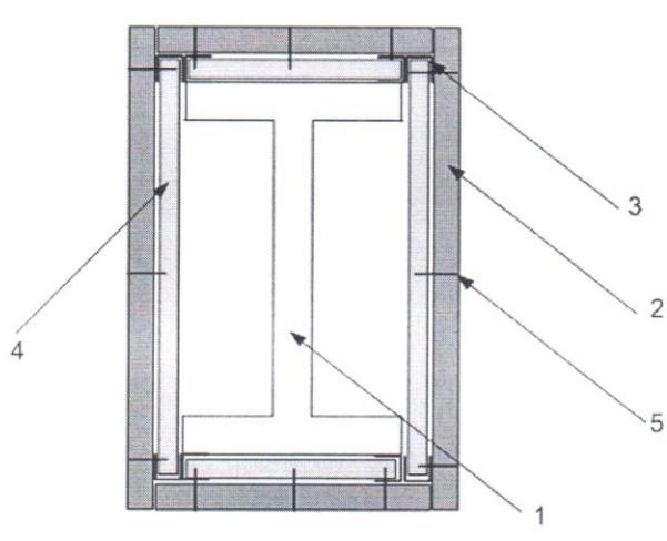
Рис.1 Монтаж плиты «ОГНЕЛИТ» при помощи алюминиевого профиля (обогрев конструкции с 4-х сторон)
