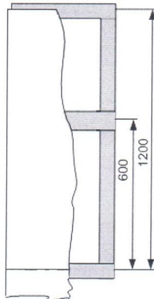
Рис. 4 Схема крепления плиты «ОГНЕЛИТ» к алюминиевому профилю
