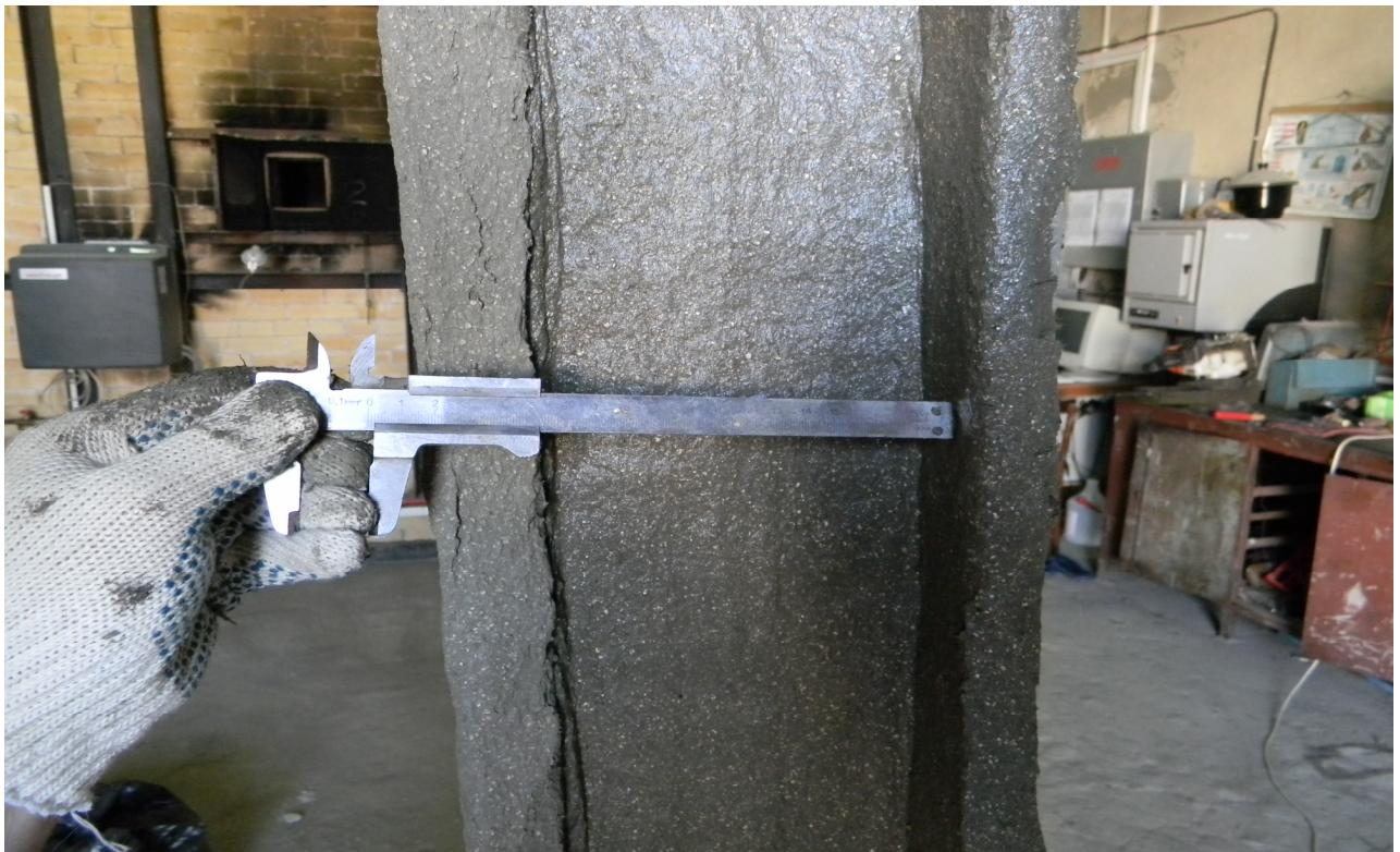
Рис. 1. Измерение толщины покрытия штангенциркулем
